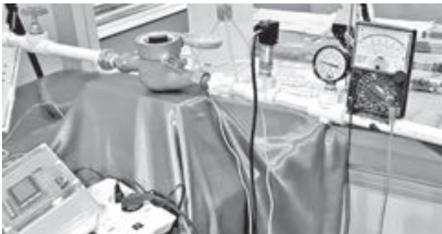
شکل ۴- کل سیستم سامانه اندازه گیری فشار کل با اجزای آن
