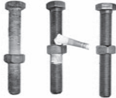
شکل ۱: مقایسه استفاده و عدم استفاده از آنتی سیز بعد از یکسال
