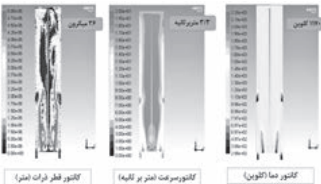
تزریق از کف کوره با تعداد ۳۶ نازل تزریق و ۲۵۰ درصد هوای مازاد
