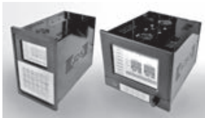
شکل ۵ - فلوکامپیوترهای کاملاً بومی طراحی و ساخته شده توسط سازمان جهاد دانشگاهی صنعتی شریف
