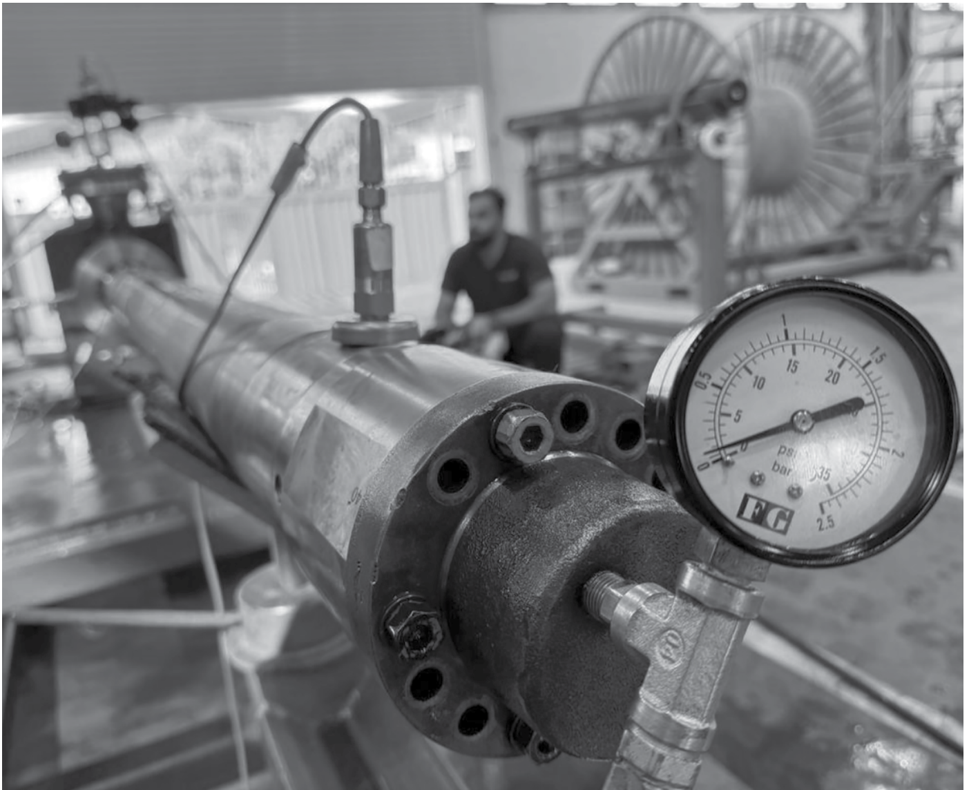
شکل ۵. نمایی از یک پروتکتور در حال آزمایش در کارخانه شرکت پادیاب تجهیز
