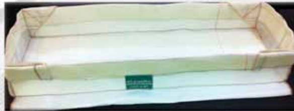
توری های نسوز با مش های مختلف جهت فیلتراسیون مذاب آلومینیوم
