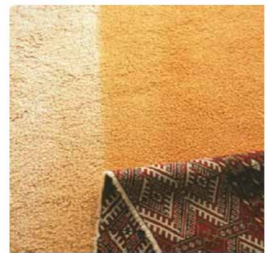
شکل ۸. نمایی از رنگ پریدگی ایجاد شده در یک موکت در اثر تابش نور خورشید
