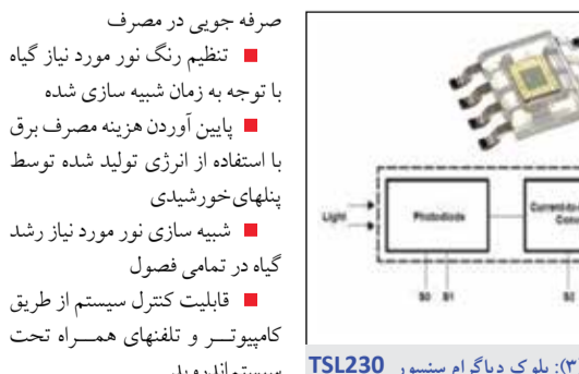
شکل شماره (۳): بلوک دیاگرام سنسور TSL230
