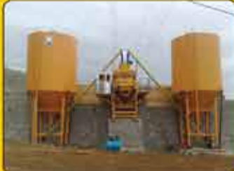
میکسر: افقی با ظرفیت نیم متر مکعب با گیربکس طرح Z-۵۰۰ و الکترو موتور ۳۰ اسب
