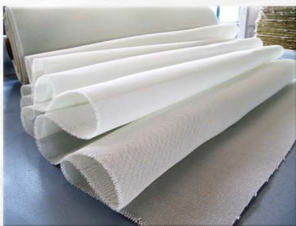
توری های نسوز با مش های مختلف جهت فیلتراسیون مذاب آلومینیوم
