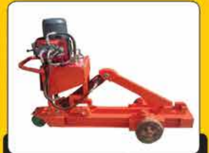
قیچی خمکن میلگرد تک فاز تا ۲۵ میلیمتر
