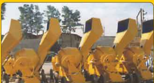
بتونیر ۵۰۰ لیتر نیمه هیدرولیک برقی و دیزل
