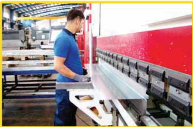
بخش برش و تازدن ورق های گالوانیزه برای ساخت قفس ها
