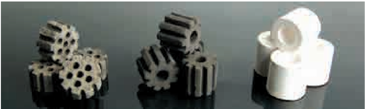
تمویر کاتالیست خشی(راست)، نیمه فعال (وسط)، و فعال(سمت چپ) مورد استفاده در ریفرمر شرکت فولاد سبزووار
