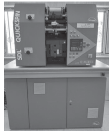
شکل ۱- نمایش از دستگاه ریسندگی چرخانه‌ای مورد استفاده.
