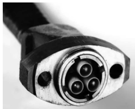
شکل ۳. تصویری از محل ارتباط کابل MLE به pot-head موتور [۱]
