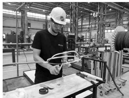
شکل ۴. عملیات اسپلایس دو سر کابل ESP در کارگاه شرکت پادیاب تجهیز
