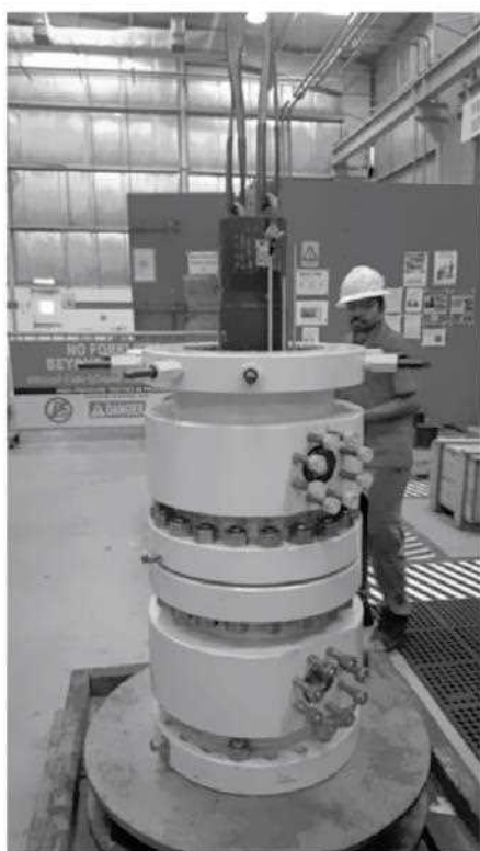
شکل ۲ شماتیک wellhead اصلاح شده و نمونه سرهم شده برای آزمایش در کارگاه [۲]
