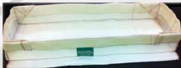
توری‌های نسوز با مش‌های مختلف جهت فیلتراسیون مذاب آلومینیوم
