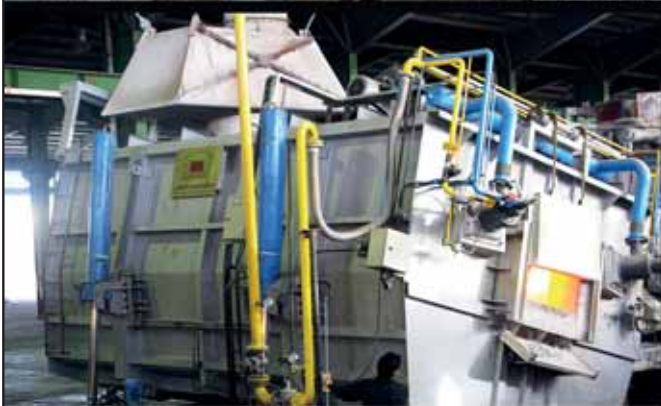
طراحی، ساخت و تسوزکاری بزرگترین کوره ذوب و نگهدارنده متحرک آلومینیومی در ایران به ظرفیت ۳۰ تن برای شرکت سیم نور پویا در سال ۱۳۸۷ در شهرک صنعتی اشتهارد
