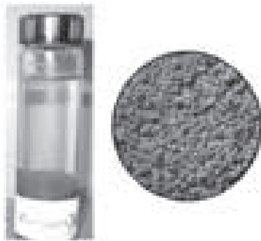
شکل ۱۶: نانو جاذب ArsenXnp تجاری‌سازی شده برای تصفیه پساب حاوی آرسنیک
