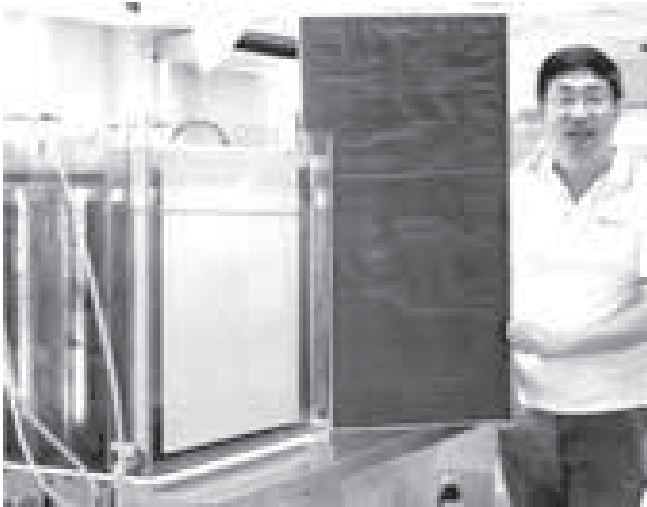
شکل ۱۵: سیستم غشاء نانوفیبر تصفیه کننده پساب ساخت شرکت CCIEC
