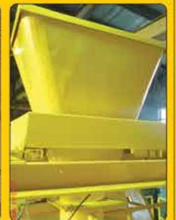
سیستم باسکول ها: شن و ماسه ۱۵۰۰ کیلوگرم با قابلیت اندازه گیری ۴ نوع مصالح به هر اندازه
