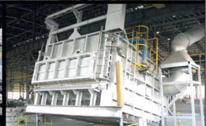
ساخت، نصب و نسوزکاری و راه اندازی یک دستگاه کوره ذوب آلومینیوم متحرک به ظرفیت ۲۵ تن برای شرکت آلومینیوم مهدی در سال ۱۳۹۴ - بندر عباس
