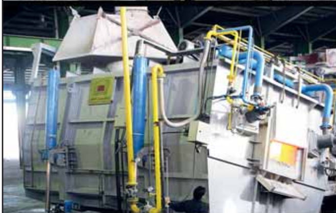
طراحی، ساخت و نسوزکاری بزرگترین کوره ذوب و نگهدارنده متحرک آلومینیومی در ایران به ظرفیت ۳۰ تن برای شرکت سیم نور پویا در سال ۱۳۸۷ در شهرک صنعتی اشتهارد
