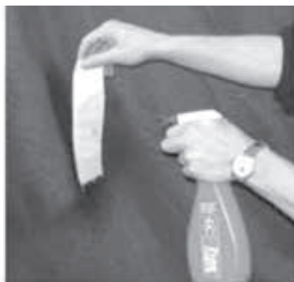
شکل ۳. نمونه‌ای از پارچه کندسوز با استفاده از نانو مواد، (الف) آزمون اشتعال پارچه ساده، (ب) عمل‌آوری پارچه با نانو مواد (ج) آزمون اشتعال پارچه تکمیل‌شده [۳]
