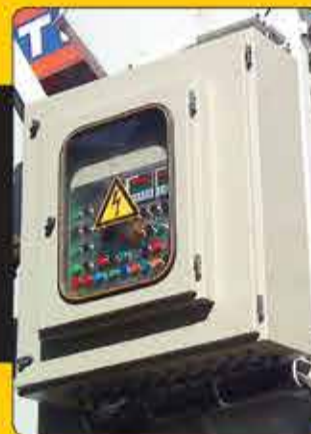
سیستم تابلو فرمان و قدرت: تابلو تمام اتوماتیک با لوازم اشنایدر با قابلیت برنامه ریزی پردازشگر دیجیتالی (سیستم PLC)
