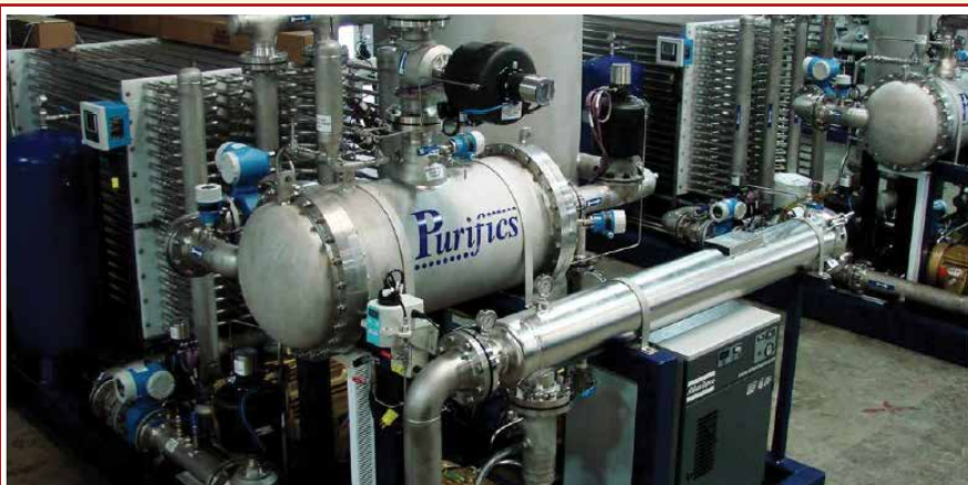
شکل ۱۳: سامانه Purifics Photo-Cat TM تجاری سازی شده برای تصفیه فتوکاتالیستی با استفاده از فناوری نانو
