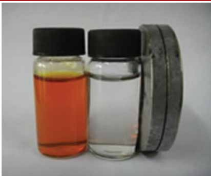
شکل ۸. حذف رنگزا با استفاده از اکسید گرافن مغناطیس شده [۱۸]
