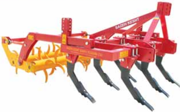
جیزل بکر ۷ شاخه سوپر با غلطک چنگالی دوبل (عرض کار ۲ متر)
