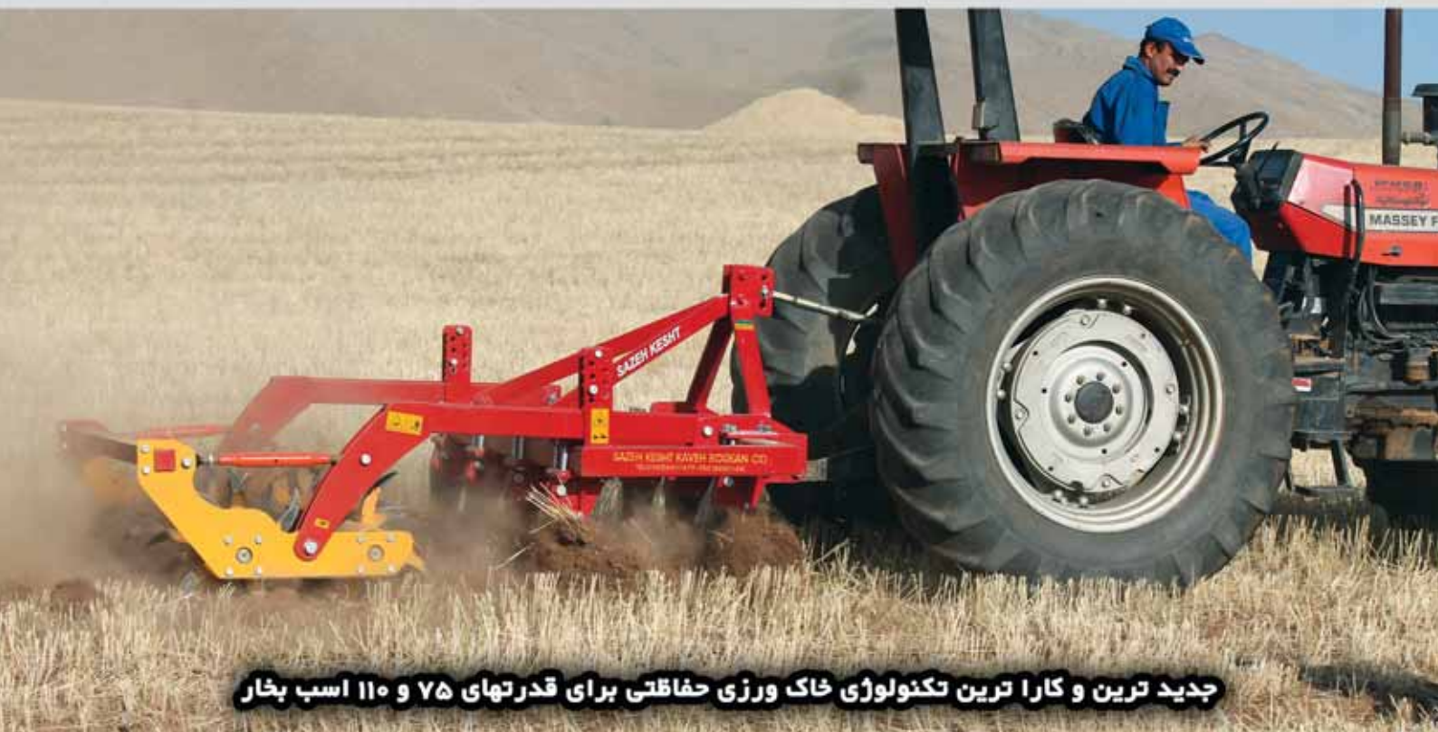
جیزل بکر ۵ شاخه سوپر با غلطک چنگالی دوبل (عرض کار ۱/۵ متر)
