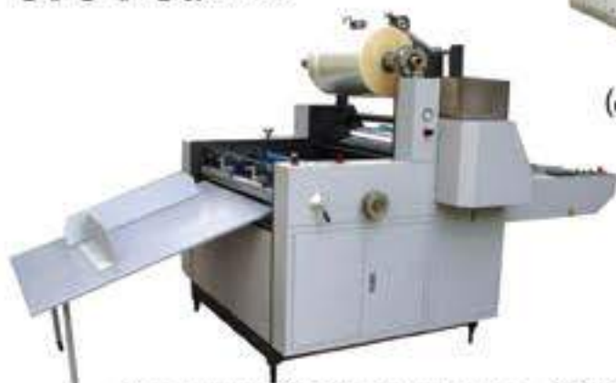
سلفون گشی حرارتی به همراه شیت کن و سیستم روغنی
