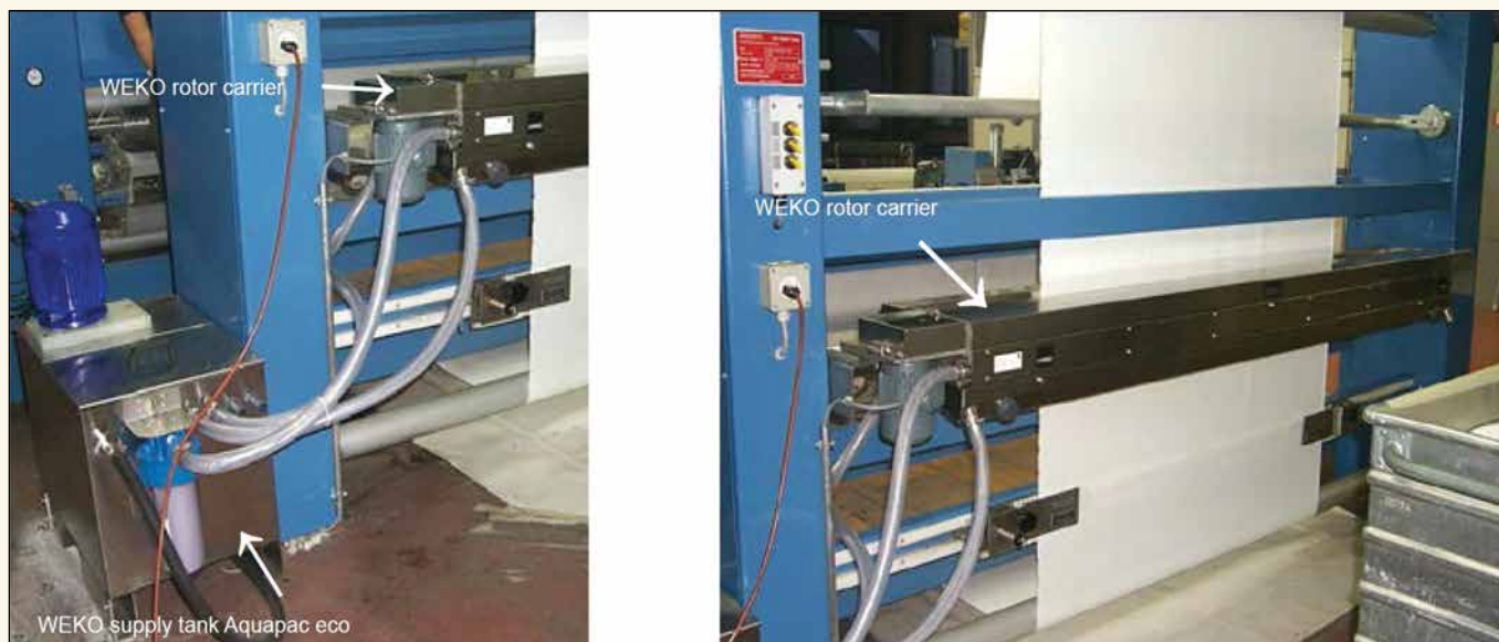
شکل ۵- راحتی نصب دستگاه وکو WEKO در بخش ورودی ماشین آلات تکمیل و مخزن جانبی آن
