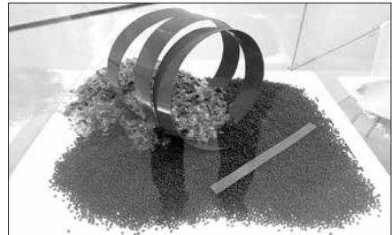
شکل ۱۷- بازیافت پرک پلی استر و تبدیل به تسمه بسته بندی در غرفه شرکت سیمما (ایتالیا) (دیتز اند شل Dietze+Schell آلمان)
