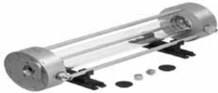
شکل ۲: سلول جذبی قرار گرفته در تجهیز نشت یابی
