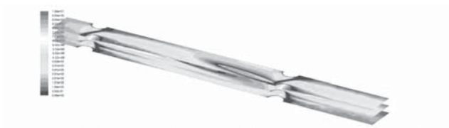
شکل ۳- تغییرات سرعت جریان در صفحات موازی گذرا از واحد ساختاری پارچه سه بعدی
