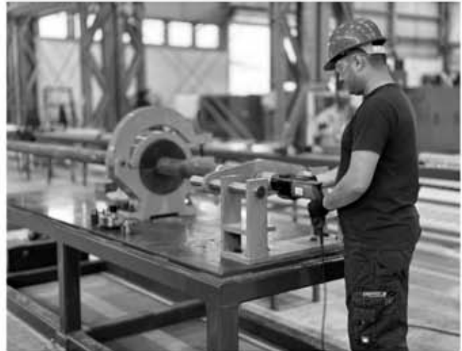
شکل ۵. اعمال گشتاور مورد نیاز به تجهیزات بر روی Torque Bench
