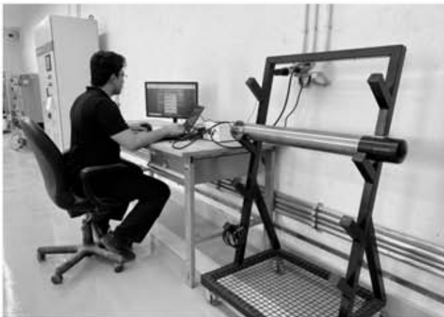
شکل ۹. آزمایش و کنترل کیفی سنسور ته چاهی
