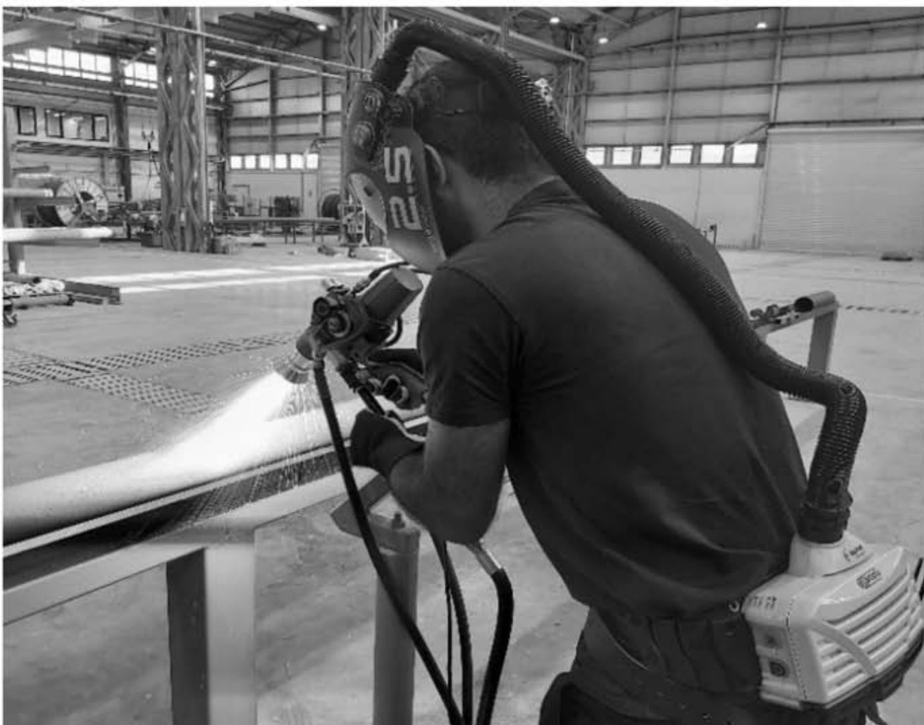
شکل ۱۰. اعمال Monel Coating بر روی سطوح تجهیزات مجموعه ESP
