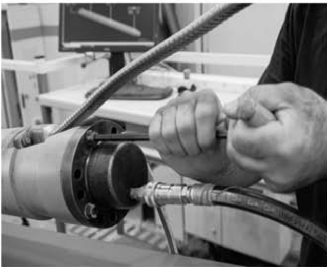
شکل ۷. آزمایش و کنترل کیفی موتور ESP
