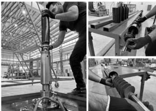
شکل ۴. نماهایی از مونتاز پمپ، RGS و پروتکتور
