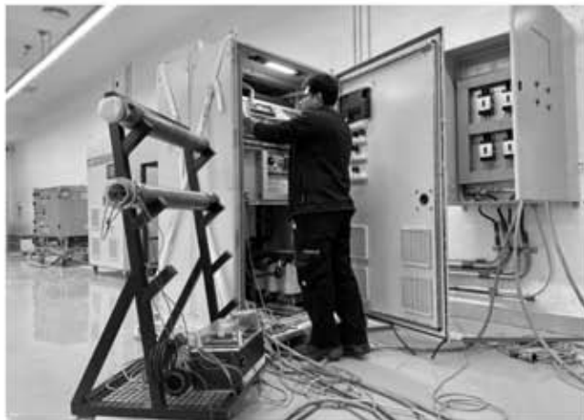
شکل ۸. ساخت، آزمایش و کنترل کیفی VFD در کارگاه برق و الکترونیک کارخانه
